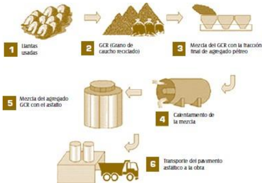
Figura 4. Proceso para la obtención de pavimento modificado convencional. Fuente: Cámara de Comercio de Bogotá (2006).
