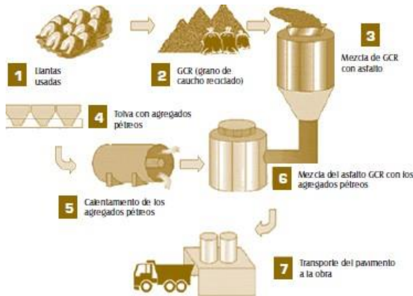
Figura 5. Proceso para la obtención de pavimento modificado químicamente.
